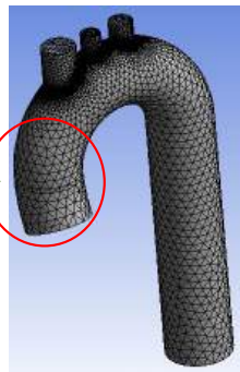
Malla de volúmenes finitos Ansys Fluent
