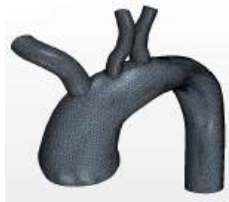
MALLA DE VOLÚMENES FINITOS DE AORTA
